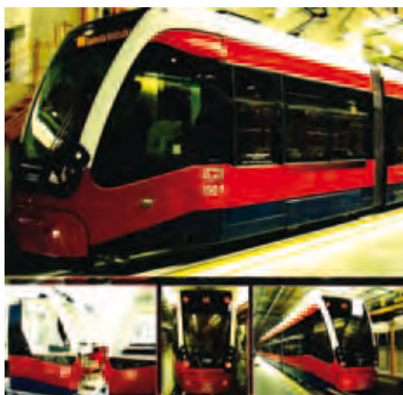
Slika 2: Izgled novih tramvaja visokog kapaciteta koji će biti niskopodni, klimatizovani, sa asinhronim motorom i modernog dizajna.
