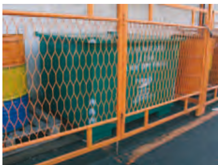
Slika 6: Specijalan kontejner za skladištenje opasnog otpada
